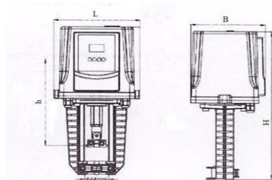
Рисунок 1 Габаритные размеры ТНК
