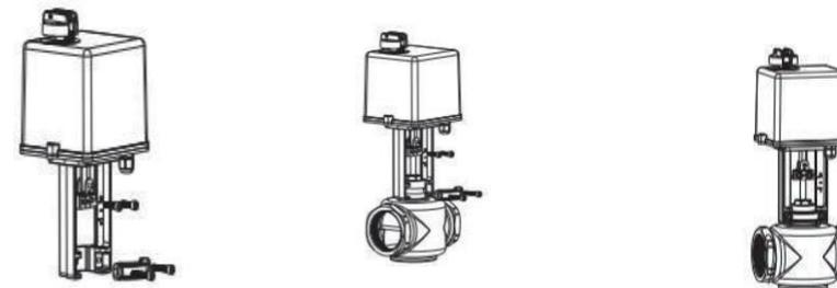
Снимите хомут с указательной стрелкой привода. Затем ослабьте хомут, охватывающий шток клапана и подготовьте привод к сборке
