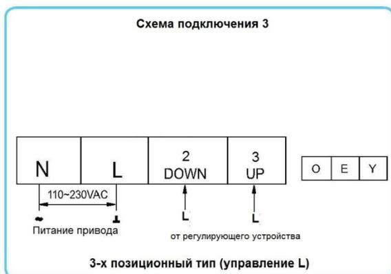
Трехпозиционное управление привода (управление приводом L - фазой).
