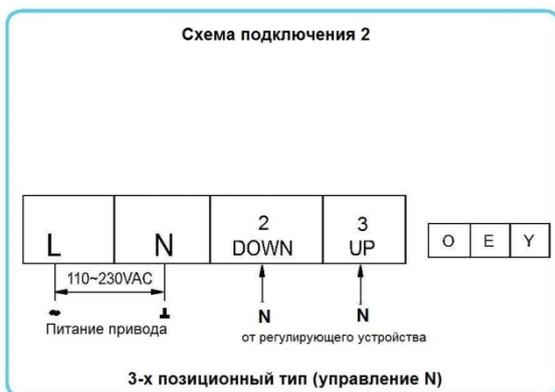
Трехпозиционное управление привода (управление приводом N- нейтралью).
