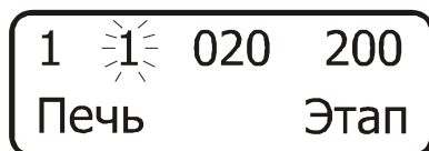
Рисунок 6 – Вид цифрового табло пульта при установке номера этапа
