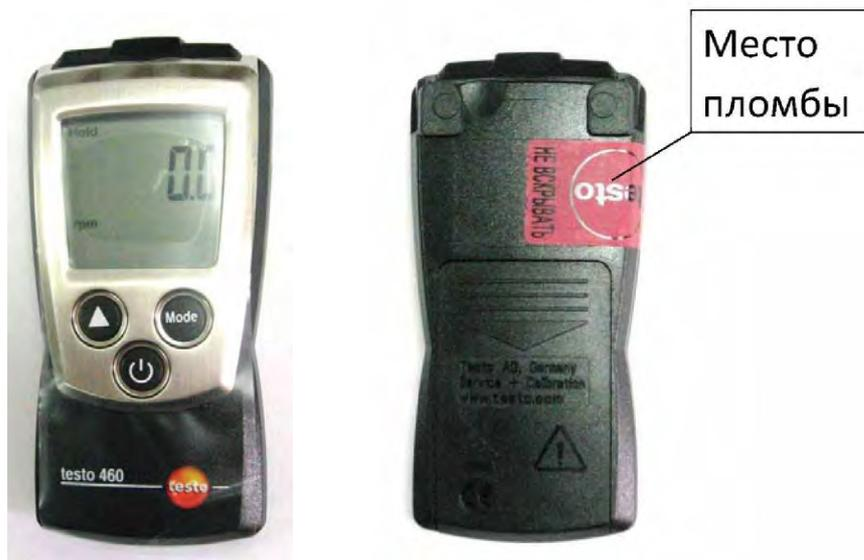
Рисунок 1. Фототахометр электронный Testo-460
