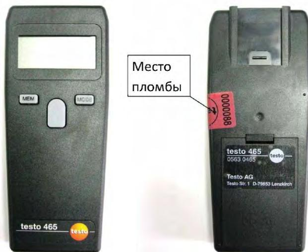
Рисунок 2. Фототахометр электронный Testo-465
