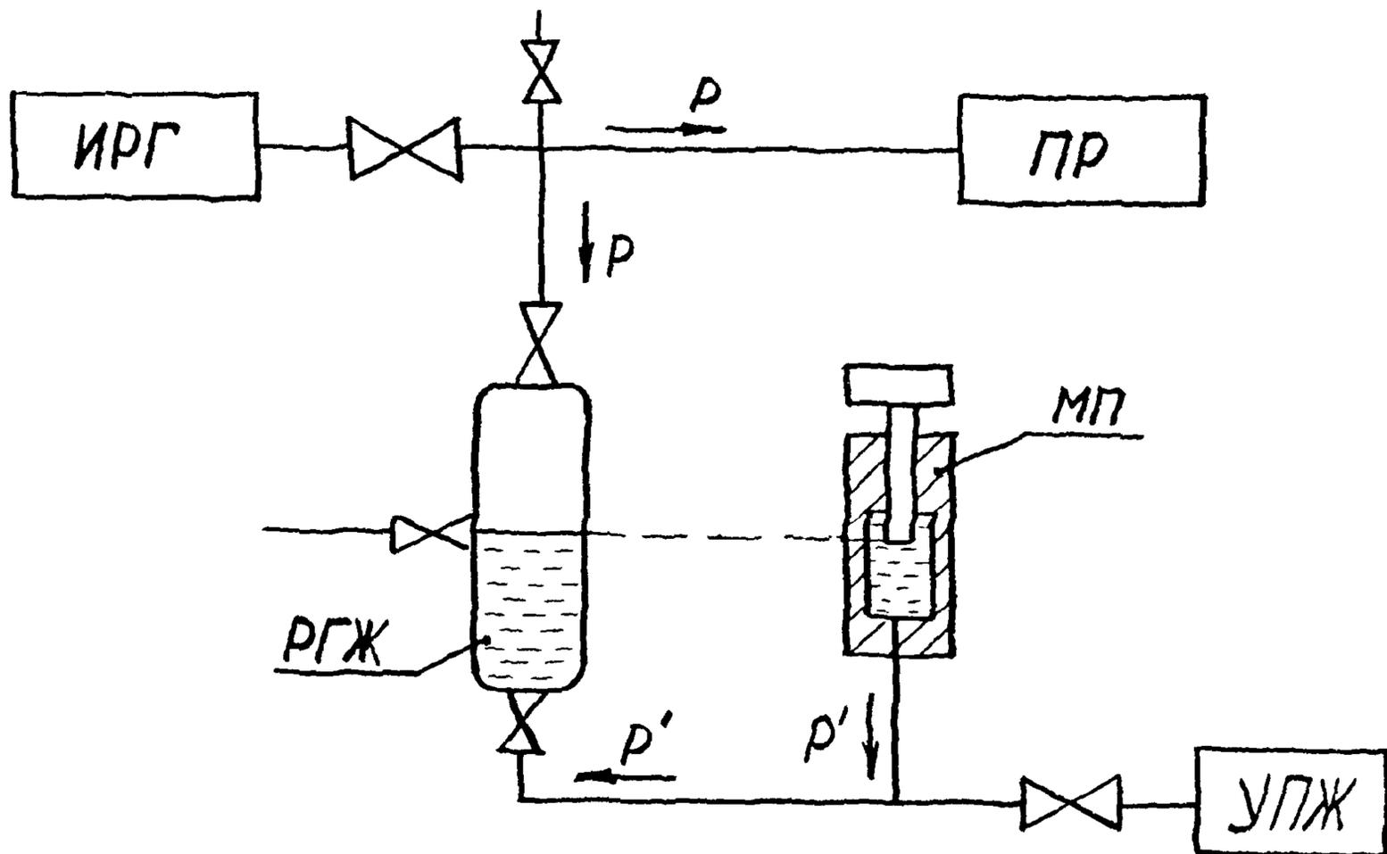
$P$  и  $P'$  - измеряемое давление и давление под поршнем МП (как правило  $P = P'$ );
