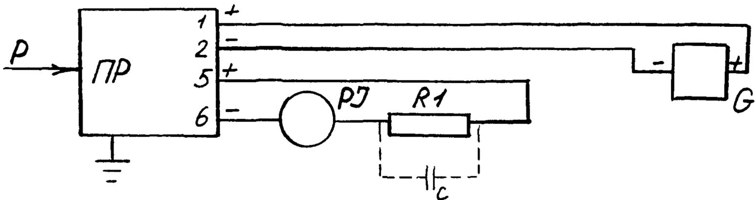
а) – подключение образцового сопротивления нагрузки к клеммам 5 и 6.
