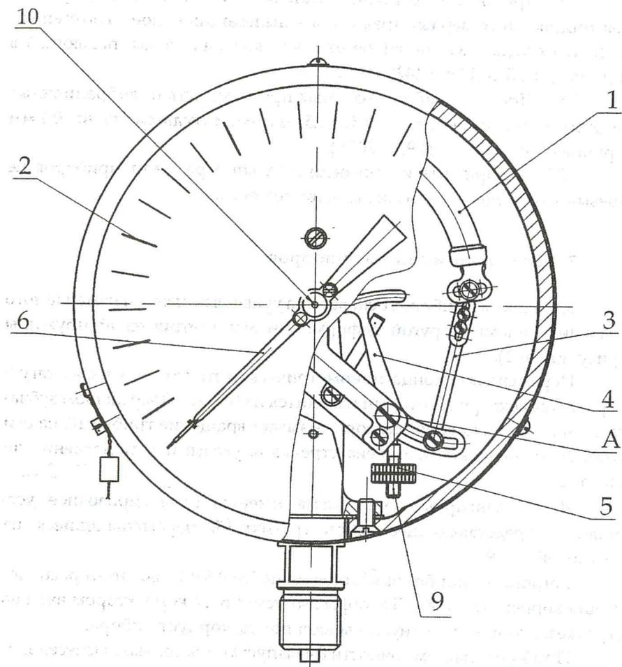
Рисунок 1 - Устройство приборов с корректором нуля на стрелке
