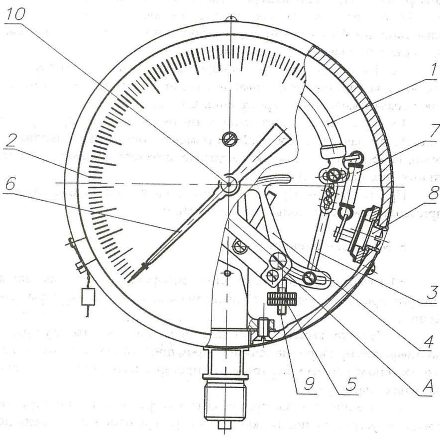
Рисунок 2 - Устройство приборов с корректором нуля на корпусе
